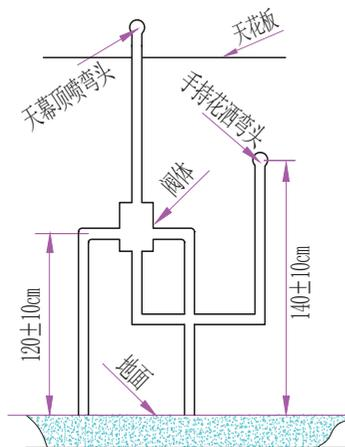
3. 按图中方式接热熔管(按实际场景选择冷热水管的接入方式及手持位置)
