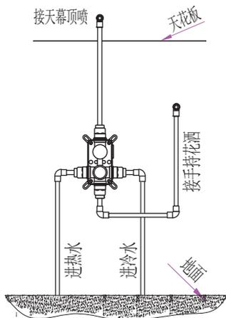
4. 按图中方式预埋弯头, 阀体。严格按阀体上标识线, 计算泥浆+精装瓷砖或大理石等其它材料预留厚度。四个定位孔须紧贴毛坯墙面。打自攻螺丝孔, 调整水平, 与墙面垂直度后紧固螺丝。
