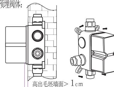
5. 瓷砖开孔8x14CM, 上适当泥浆(瓷砖+泥浆厚度不得超过2.5CM)。完成装修瓷砖墙面后, 取出预埋盒盖板。
