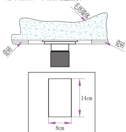
6. 用六角螺丝刀, 拆开分水手轮, 装上面板, 然后再装回手轮, (不需要拆除数显手轮)
