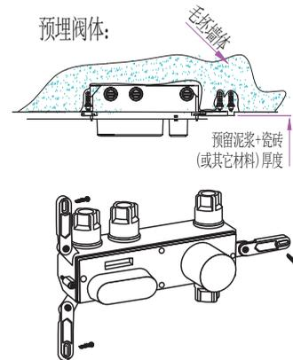
5. 瓷砖开孔24x7CM(注意留出自攻螺丝位置，以便上面板)，上适当泥浆后须紧贴四个定位片。（瓷砖+泥浆厚度不得超过2.5CM）。完成装修瓷砖墙面后，取下固定螺丝并取出预埋盒盖板。
