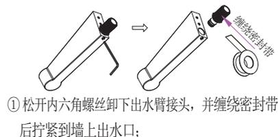
① 松开内六角螺丝卸下出水臂接头，并缠绕密封带后拧紧到墙上出水口；
