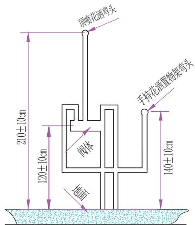
3. 按图中方式接热熔管（按实际场景选择冷热水管的接入方式及置物架位置，尽量不交叉水管）
