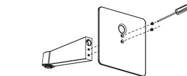
③ 将出水臂扣入接头，用小六角扳手紧锁螺丝。
