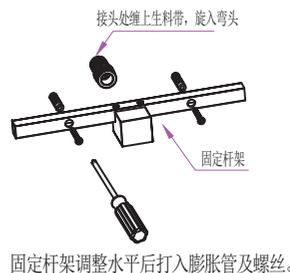
固定杆架调整水平后打入膨胀管及螺丝。
