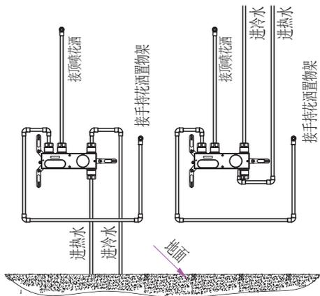
4. 按图中方式预埋手持花洒置物架弯头、阀体。严格按阀体上标识线，计算泥浆+精装瓷砖或大理石等其它材料预留厚度。三个定位片须紧贴毛坯墙面。打自攻螺丝孔，调整水平，与墙面垂直度后紧固螺丝。
