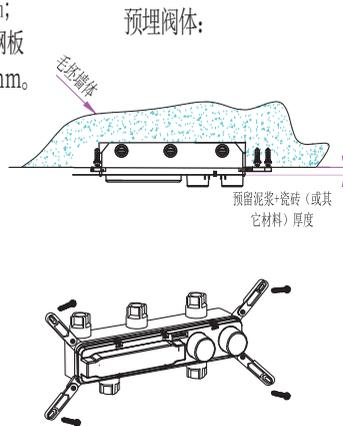
5. 瓷砖开孔38x9CM，上适当泥浆后须紧贴四个定位片。（瓷砖+泥浆厚度不得超过2.5CM）。
