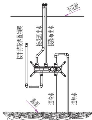
4. 按图中方式预埋手持花洒置物架弯头、阀体。严格按阀体上标识线，计算泥浆+精装瓷砖或大理石等其它材料预留厚度。四个定位片须紧贴毛坯墙面。打自攻螺丝孔，调整水平，与墙面垂直度后紧固螺丝。
