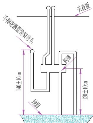
3. 按图中方式接热熔管（按实际场景选择冷热水管的接入方式及置物架位置，尽量不交叉水管）
