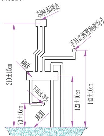
3. 按图中方式接热熔管 (按实际场景选择冷热水管的接入方式及置物架位置, 尽量不交叉水管)
