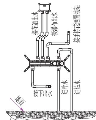
4. 按图中方式预埋手持花洒置物架弯头、阀体。严格按阀体上标识线, 计算泥浆+精装瓷砖或大理石等其它材料预留厚度。四个定位片须紧贴毛坯墙面。打自攻螺丝孔, 调整水平, 与墙面垂直度后紧固螺丝。
