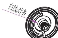
旋转恒温阀芯, 使杆白线与体白线对齐 (出厂时已旋转对齐)。按图中方向装好旋钮 (旋钮突出杆向上对齐居中)。
