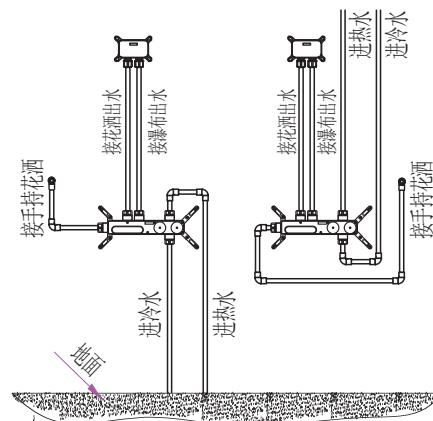
4. 按图中方式预埋弯头, 阀体。严格按阀体上标识线, 计算泥浆+精装瓷砖或大理石等其它材料预留厚度。四个定位片须紧贴毛坯墙面。打自攻螺丝孔, 调整水平, 与墙面垂直度后紧固螺丝。
