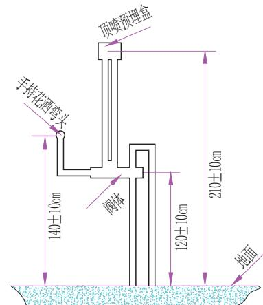
3. 按图中方式接热熔管 (按实际场景选择冷热水管的接入方式及手持位置, 尽量不交叉水管)
